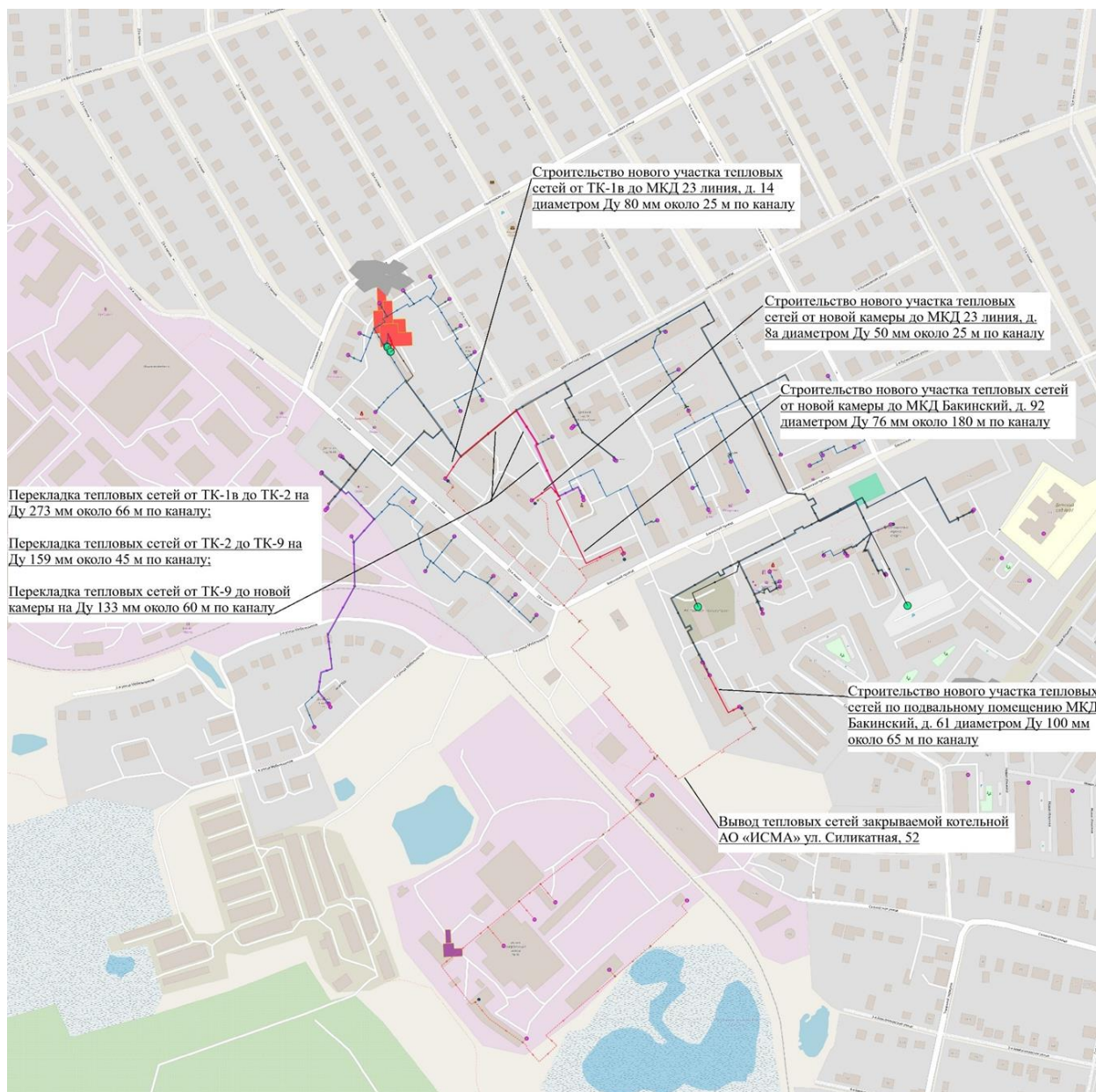
Рис. 4.4. Схема места расположения предлагаемого строительства участка тепловой сети для переключения потребителей закрываемой котельной АО «ИСМА» на котельную ООО «Система Альфа».
