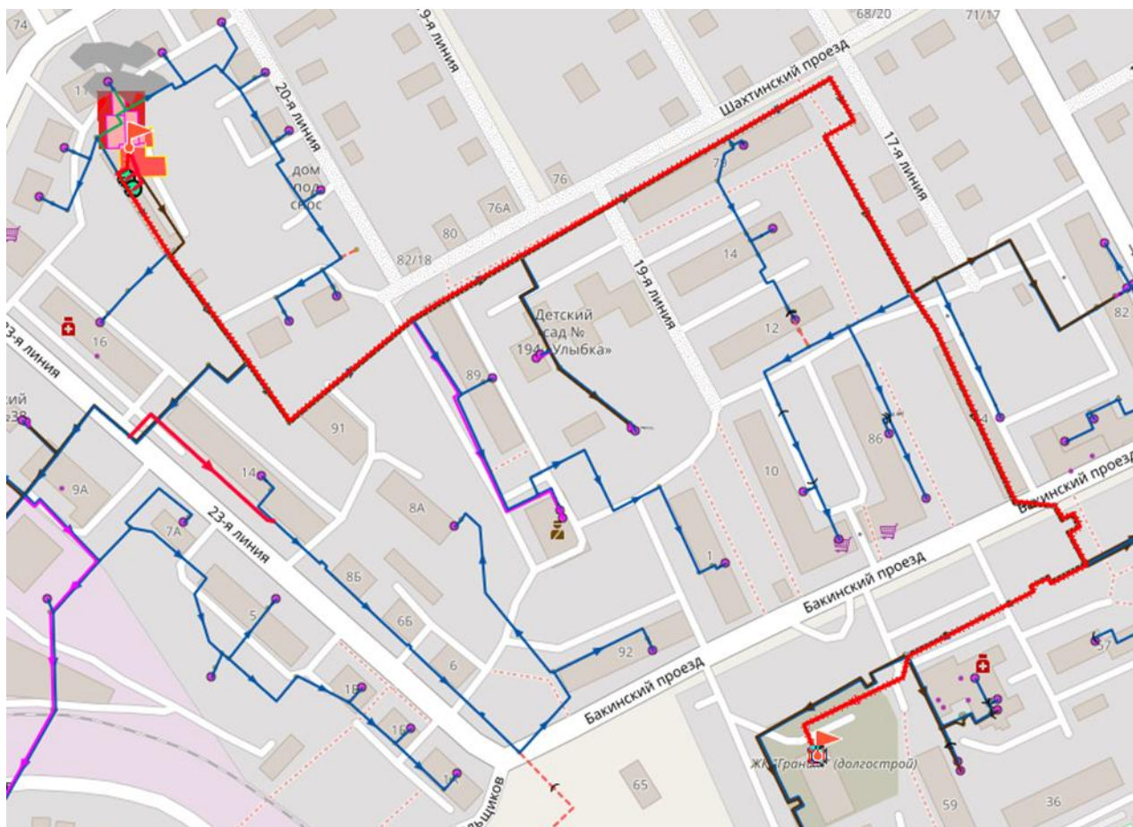
Рис. 4.5 Путь движения теплоносителя от источника: Котельная (ООО «Система Альфа») ул. 23 Линия, 18 до переключаемого потребителя.
